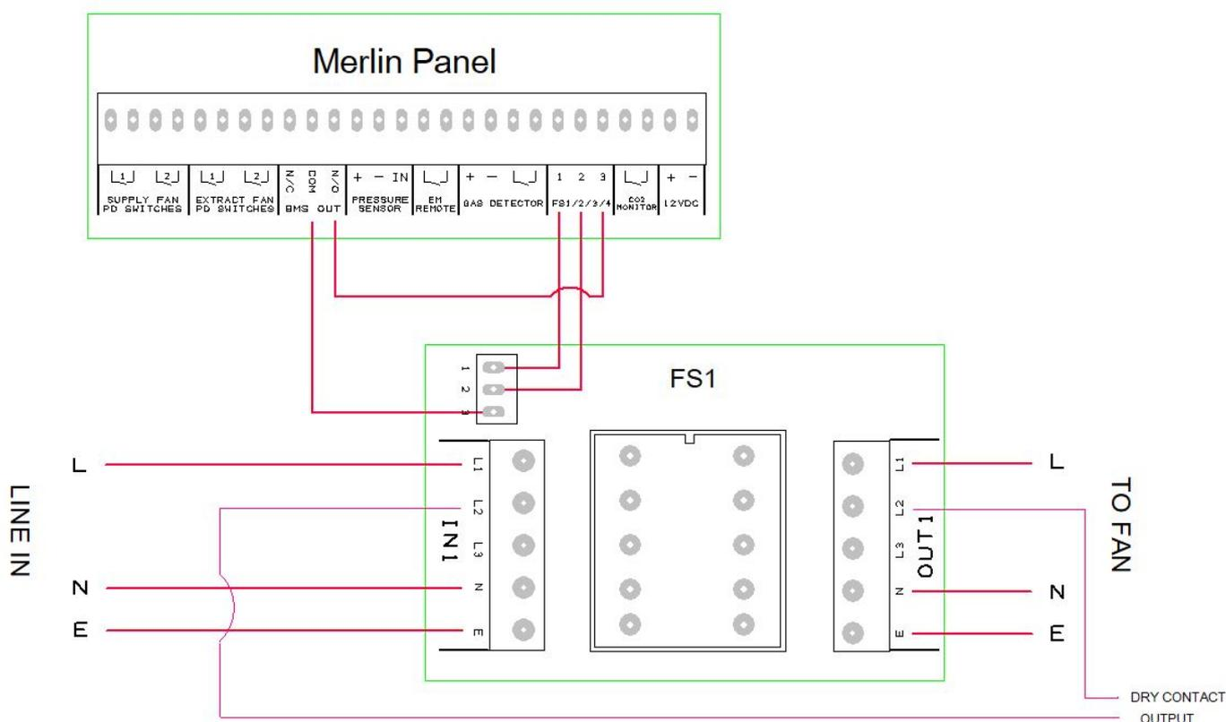
**⚠ Le commutateur DIP de sélection BMS du panneau utilitaire Merlin doit être réglé sur la position ON!**
